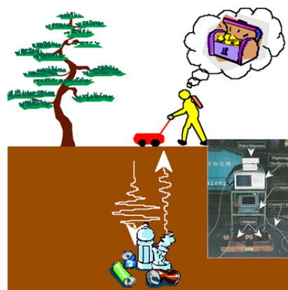
図 2 地中探査レーダ
