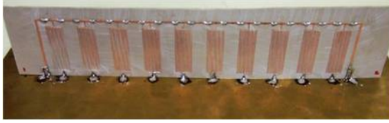
図2 UHF 帯広帯域漏れ波アンテナ
