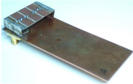
図4 携帯端末用小形広帯域アンテナ
